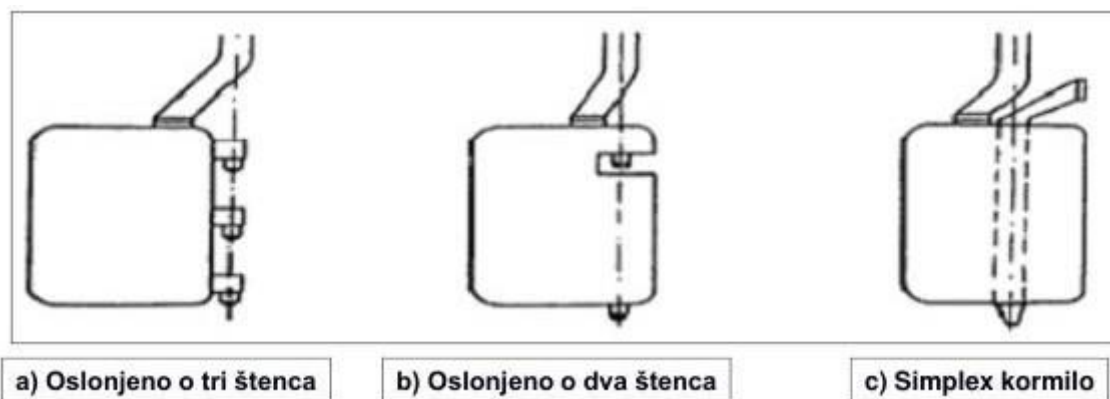
Slika 12. Podjela kormila prema načinu pričvršćenja za trup
