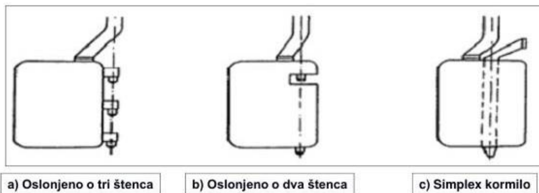
Slika 12. Podjela kormila prema načinu pričvršćenja za trup
