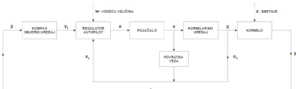
Slika 17. Blok shema automatskog upravljanja kormilarskim uređajem<sup>30</sup>
