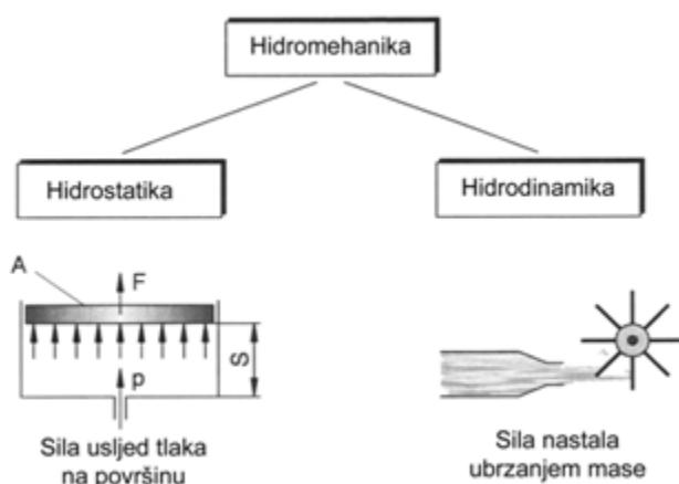
Slika 7. Podjela hidrodinamičkih sustava<sup>16</sup>
