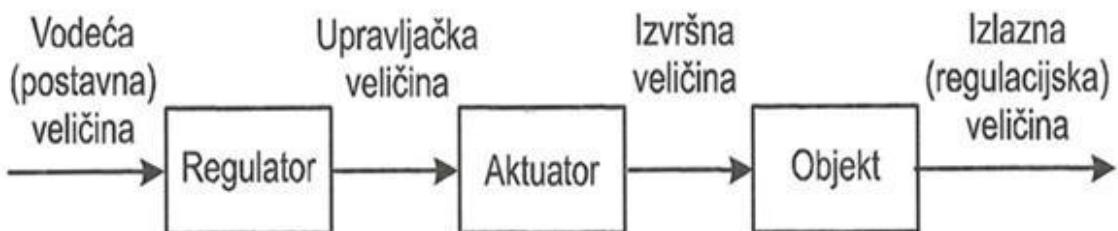
Slika 5. Blok dijagram otvorenog sustava
