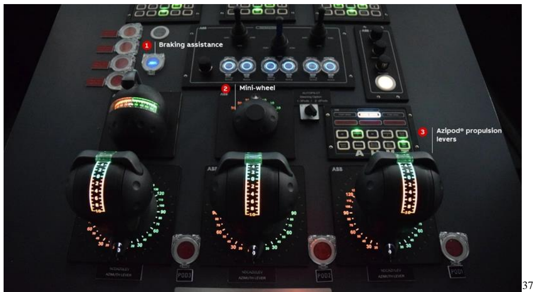
Slika 24. Kontrole za upravljanje brodom
