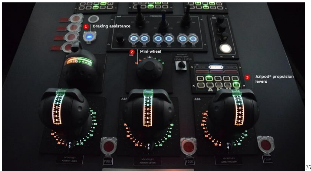
Slika 24. Kontrole za upravljanje brodom
